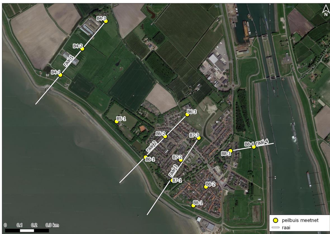
Afbeelding 4.5 Overzicht meetraaien en peilbuizen Hansweert
