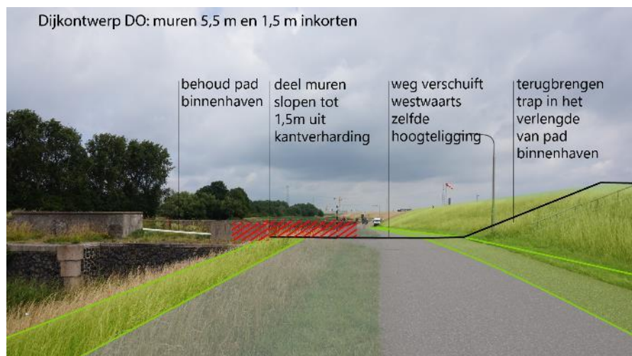
Afbeelding 3.5 Gekozen inpassing sluishoofd waarbij muren worden
