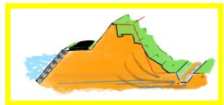
Micro instabiliteit piping
