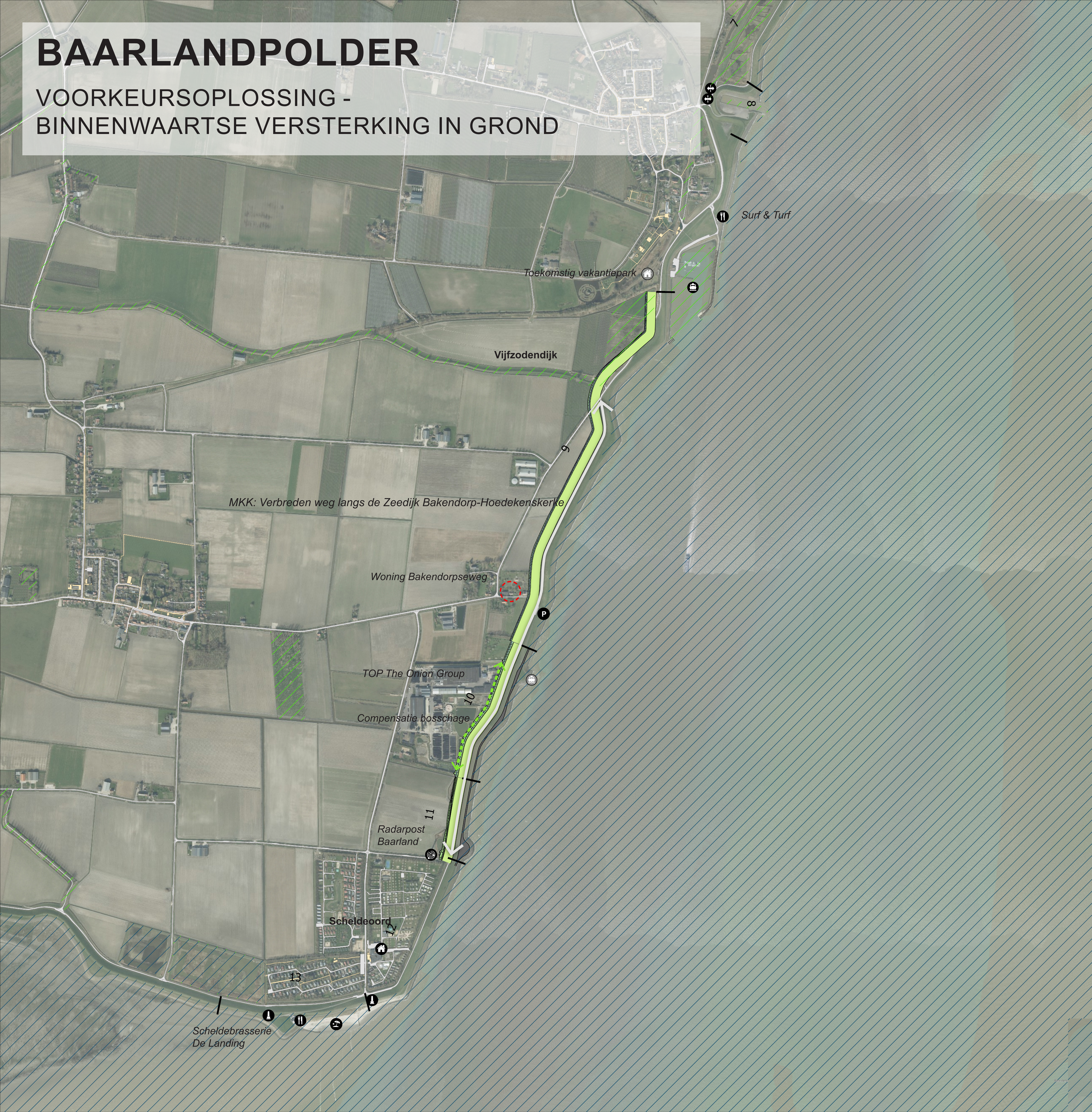
Dijkvak 9. Pipingoplossing in grond Dijkvak 10. Stabiliteits- en pipingoplossing in grond; harde bekleding buitentalud Dijkvak 11. Stabiliteits- en pipingoplossing in grond; harde bekleding buitentalud
