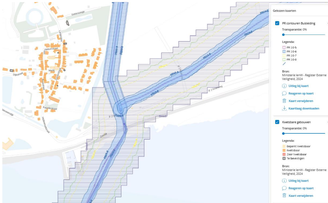
Figuur 4.1 | Buisleiding in dijkvak 14 met risico- en aandachtsgebieden en ligging van (beperkt) kwetsbare objecten (bron: atlasleefomgeving.nl)
