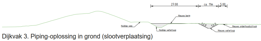
Dijkvak 3. Piping-oplossing in grond (slootverplaatsing)
