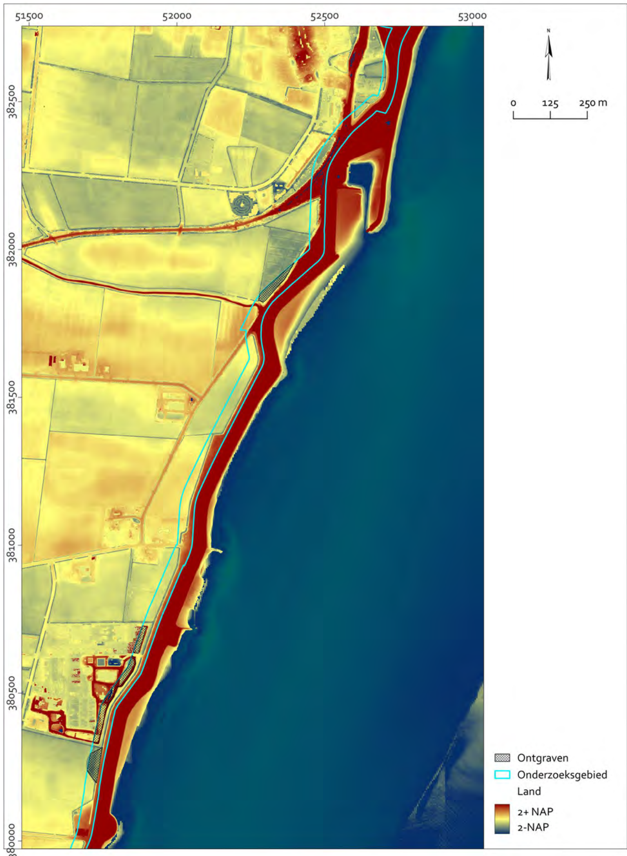
Figuur 20 Detailprojectie van het onderzoeksgebied (in lichtblauw) op bewerkte uitsnede Actueel Hoogtebestand Nederland. De zones waar ontgravingen hebben plaatsgevonden zijn gearceerd. Bron: www.pdok.nl (AHN 4 0,5 meter raster DTM).
